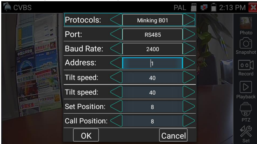
Рис.63 Настройки PTZ для управления через RS-485
