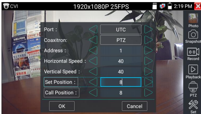
Рис. 79 Настройка заданной позиции и вызов пресета
