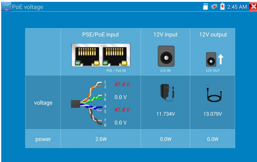
Рис. 112 Интерфейс приложения «PoE тестер»
