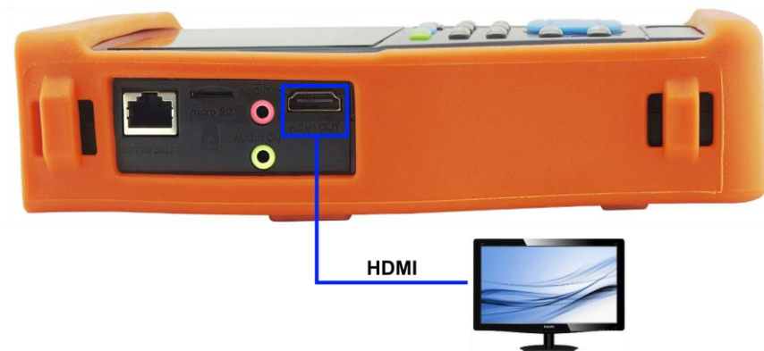
Рис. 11 Подключение тестера к HDMI-монитору
