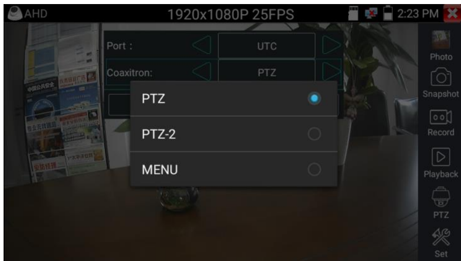
Рис.85 Выбор настроек для управления AHD PTZ видеокамерой по коаксиальному кабелю
