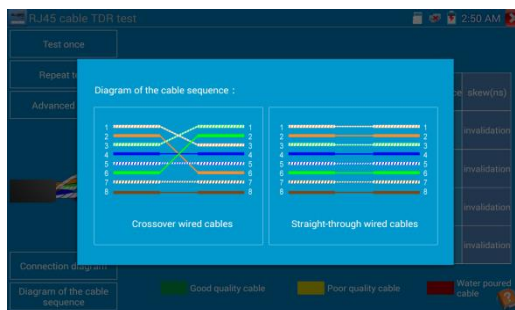
Рис. 105 Типы обжимки кабеля «витой пары»
